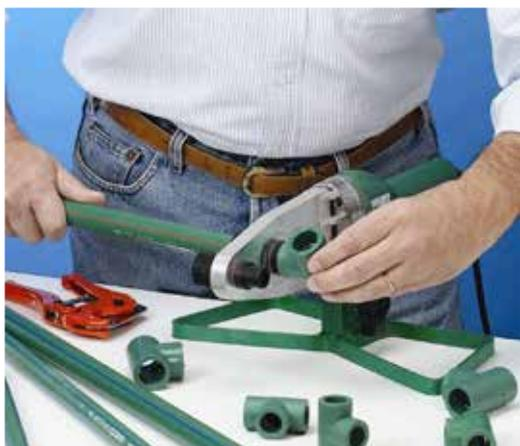
É o sistema inteligente de condução de água quente, fria, gelada e de ar comprimido para as prumadas, ramais, chuveiros e torneiras, sem corrosão e vazamentos, produzido em polipropileno copolímero random, com união por Termofusão.
