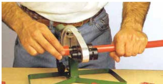
É o primeiro piso térmico do continente americano com união por Termofusão. O sistema inclui o tubo de polietileno de alta resistência (PERT) e os coletores e conexões de regulagem necessários para distribuir a água quente e gelada, garantindo o mais alto grau de conforto da calefação e para as indústrias de refrigeração.
