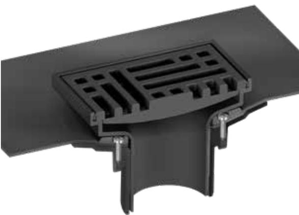
I. Finalmente, desliza-se o Sobre Ralo dentro do Corpo. A longitude do Sobre Ralo permite uma ampla regulagem da altura final da grelha, dependendo da espessura da camada de contrapiso e do revestimento. No caso do ralo horizontal, uma vez determinada a altura final do piso acabado, deve-se cortar o comprimento do sobre ralo excedente para evitar que o mesmo obstrua o trecho horizontal.
