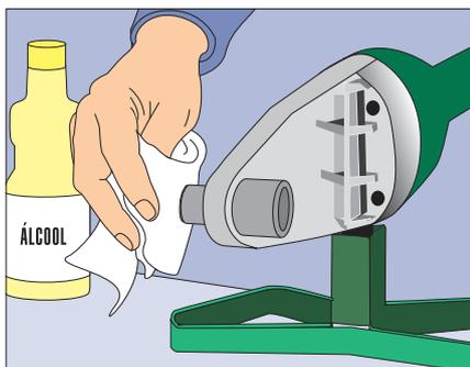
**1.** Ao começar o trabalho ou cada vez que for necessário, limpar os bocais do termofusor com um pano umedecido em álcool e verificar seu correto ajuste sobre a placa de alumínio.
