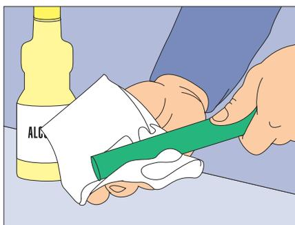
**3.** Limpar a ponta do tubo e o interior da conexão com um pano umedecido em álcool comum, pouco antes de efetuar cada Termofusão.
