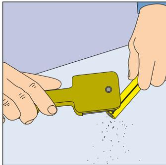
2. Raspe a superfície exterior do tubo a ser eletrofusionado. Limpe essa superfície e o interior da conexão com álcool comum.
