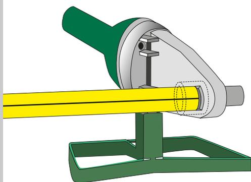
A fusão se realiza por contato direto das superfícies a serem unidas, que devem encontrar-se em estado plastificado. Ao terminar o processo de fusão molecular pode-se observar, na união, um cordão visível formado pelo próprio movimento do material plastificado. A temperatura nos bocais pode oscilar entre 245° e 275°. A temperatura de equilíbrio é 260°.
