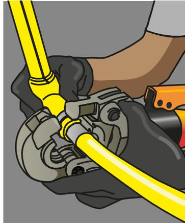
**4.** Encaixar a conexão dentro da matriz fixa da ferramenta, girar a conexão no ângulo determinado em relação ao tubo. Para fechar o mordente, os cabos devem ficar completamente abertos, empurre a matriz móvel até fechá-la.
