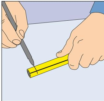
3. Marque sobre cada extremidade dos tubos a serem eletrofusionados a medida de inserção dos mesmos na conexão ou luva elétrica (esta medida vem indicada na luva).
