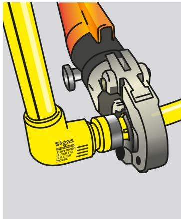
**5.** Acionar a prensa fechando os cabos até o final, abrir as matrizes da ferramenta pressionando a alavanca lateral. Os cabos devem estar completamente abertos. processo de crimpagem concluído, transição realizada.
