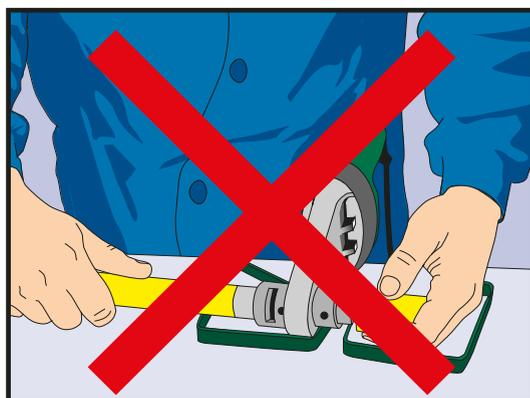
Não é possível unir os tubos Sigas FLEX com as conexões Sigas Termofusão mediante termofusão direta.
