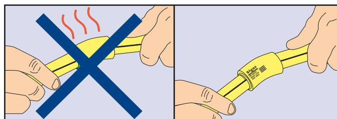
4. Não submeta as termofusões realizadas a tensões desnecessárias (giros, movimentos, deslocamentos, esforços) durante a etapa de resfriamento. Os tubos Sigas Termofusão não devem ser dobrados; para realizar desvios utilize as conexões que fazem parte do sistema (COTOVELOS DE 90° e COTOVELOS DE 45°)
