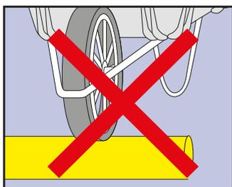
Deve-se ter um cuidado especial no armazenamento, de modo a evitar choques mecânicos, como esmagamento da tubulação multicamada.
