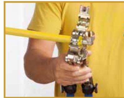
**Nota:** Depois de finalizado o processo de união, a conexão ficará impossibilitada de realizar qualquer tipo de movimento de torção no tubo multicamada.
