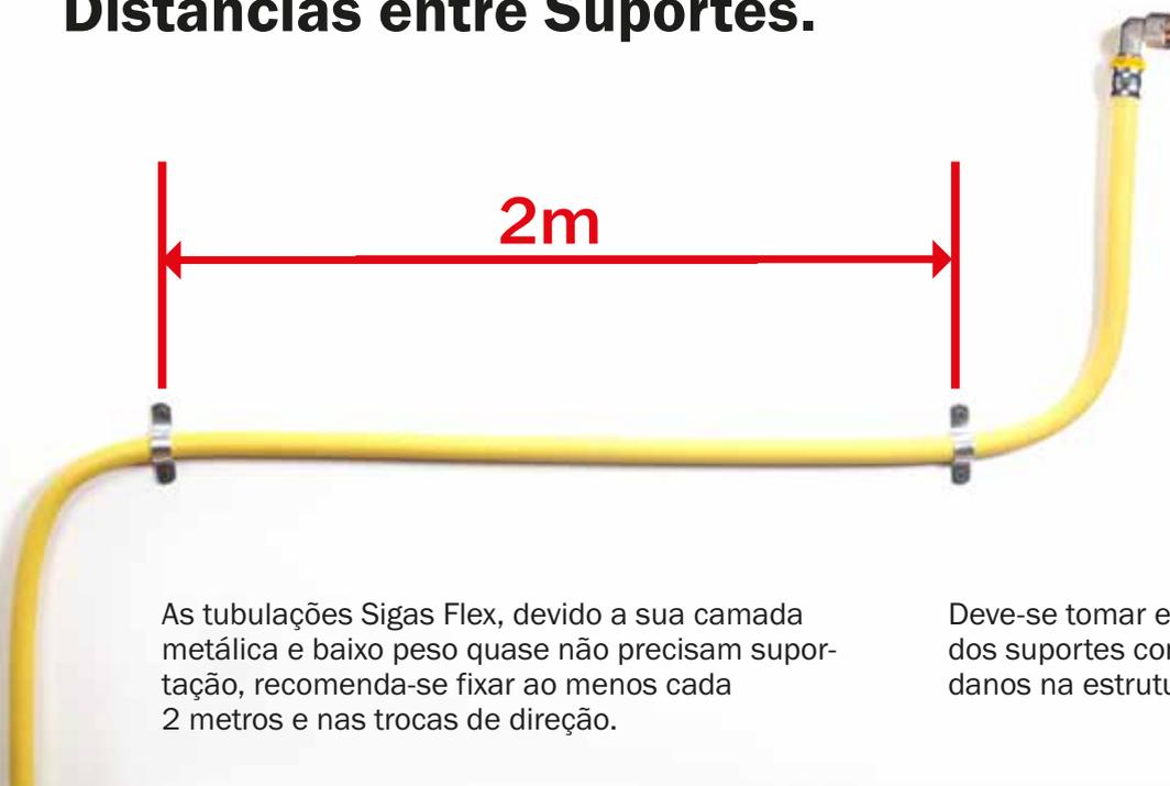
As tubulações Sigas Flex, devido a sua camada metálica e baixo peso quase não precisam suporta-ção, recomenda-se fixar ao menos cada 2 metros e nas trocas de direção.
