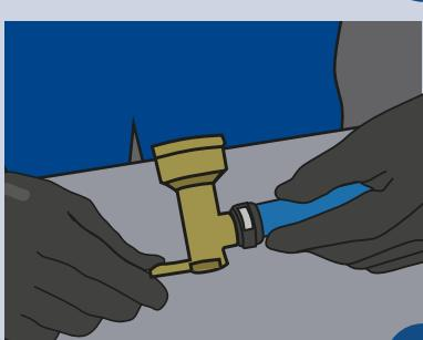
3. Insira o tubo até a extremidade da conexão.
