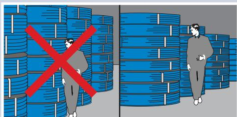
Os rolos de Acqua System Flex não devem ser empilhados com alturas superiores a 1,50m e devem ser colocados sobre superfície plana. Em casos de superfícies irregulares ou abrasivas, sugerimos apoiar os rolos sobre pallets.
