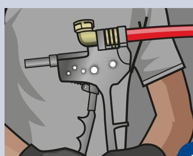
6. Acione a prensa, abrindo e fechando seus cabos, até que o anel encoste na conexão.
